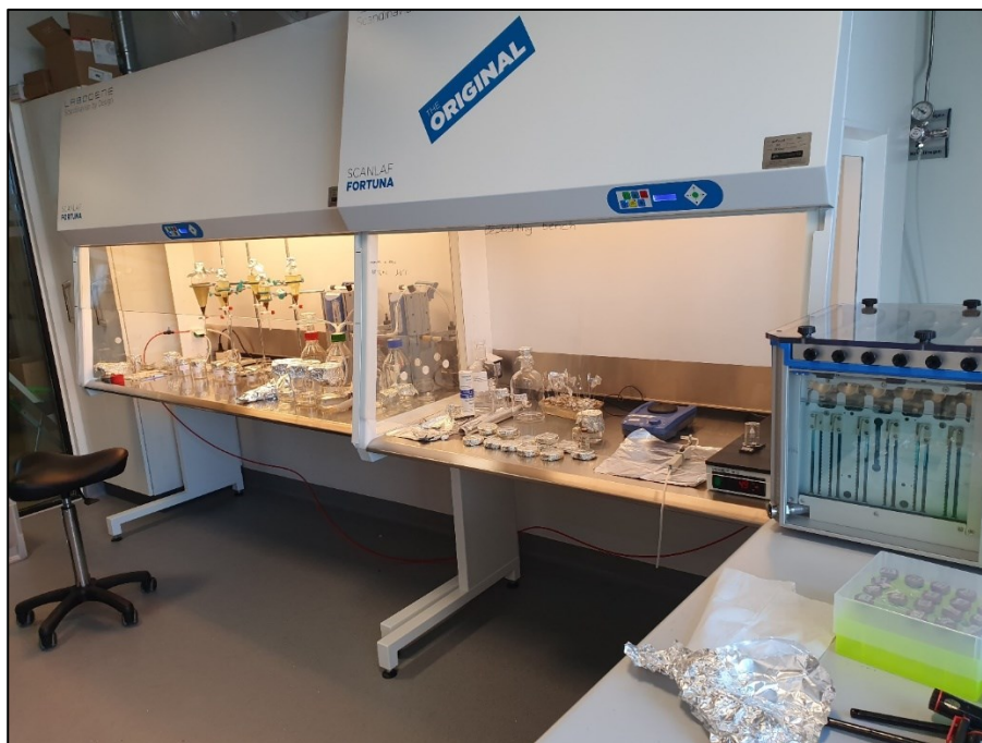
Figur 12. Laminært flowskab med luftrensning til at sikre renrumsforhold under mikroplast analyse
