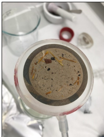
Figur 9. Materiale på et Ø47 stålfilter med 10 \mu\text{m} porestørrelse
