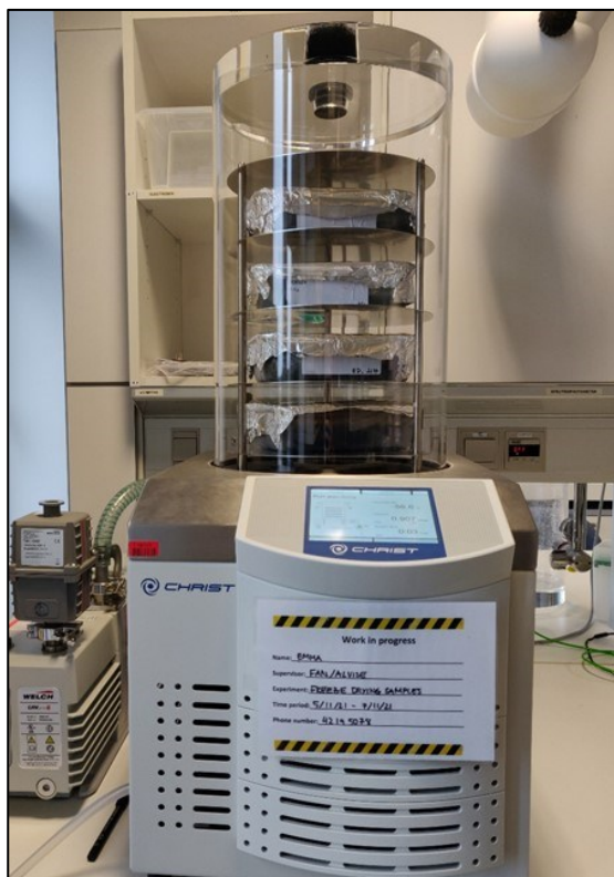
Figur 7. Frysetørring af partikler <2 mm efter vådsigtning
