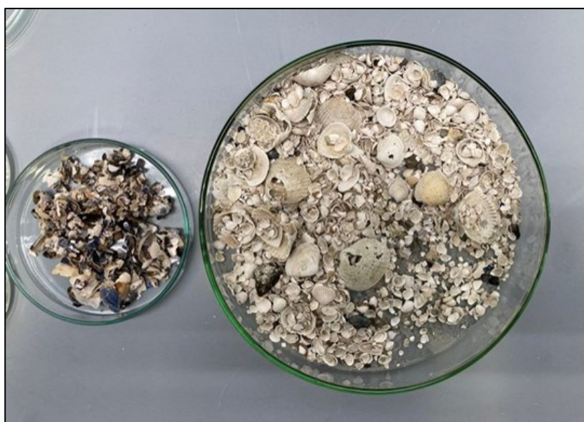
Figur 6. Materiale samlet på 2 mm sigte, der derpå manuelt sorteres i mulige kandidater for mikroplast
