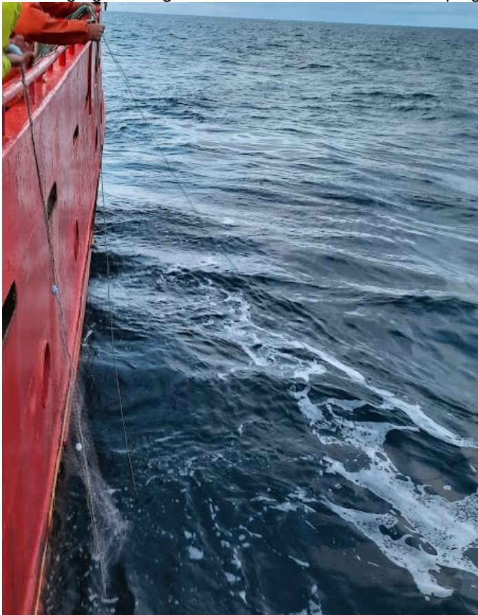
Figur 4.5. Sætning af garn offshore fra stort fartøj. Et besætningsmedlem firer løbende garnet ud under naturlig drift af fartøjet med vind og strøm. Besætningsmedlemmet tilser løbende, at overlig og underlig ikke er snoet sammen.
