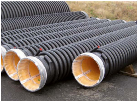
Energioptag fra afløbsrør, producent Frank
