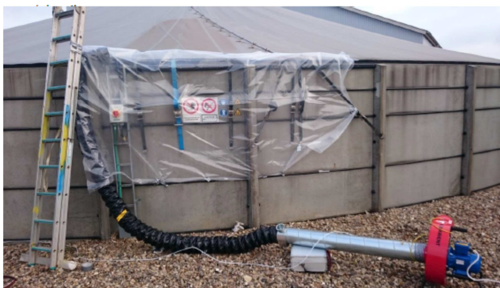
Figur 2 Eksempel på bestemmelse af metantab fra en enkelt kilde. Udsivende biogas fra en tank opsamles vha. afdækning og en blæser. Gasflow og metankoncentration i gassen måles, og metantabet beregnes som produktet af de to. Ved denne metode skal det sikres, at der ikke suges biogas ud fra kilden. Se evt. Bilag 2.
