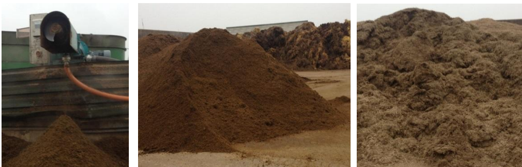
Billede 23: Kompostering af afgassede fibre og halm på Holbæk Biogas. Fiber (til venstre og midt), blanding af halm og fibre til højre.
