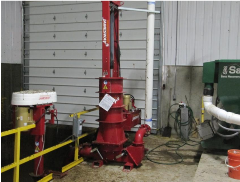
Billede 47: Jamesway stempelpumpe der suger fra åben fortank og pumper til sandkanon
