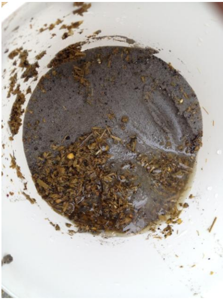
Billede 28: Skyllet sand i rågylle fra kvægproduktion med sand i sengebåsene. Sandet udgør ca. 10% af vægten.
