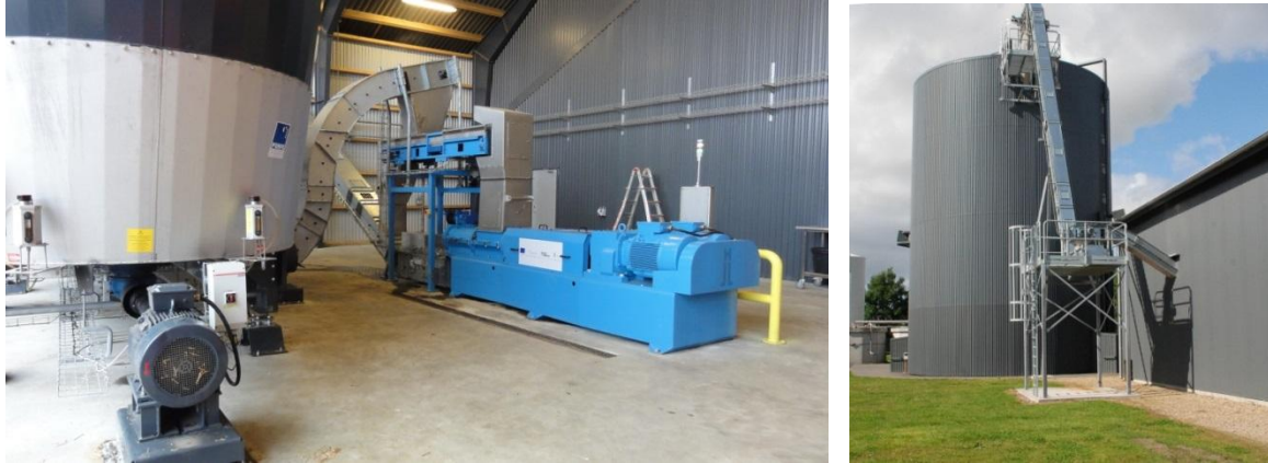
Billede 21: Mikseren til venstre føder den oprevne biomasse ind i ekstruderen (blå), hvorfra den føres videre til reaktor tanken (til højre)
