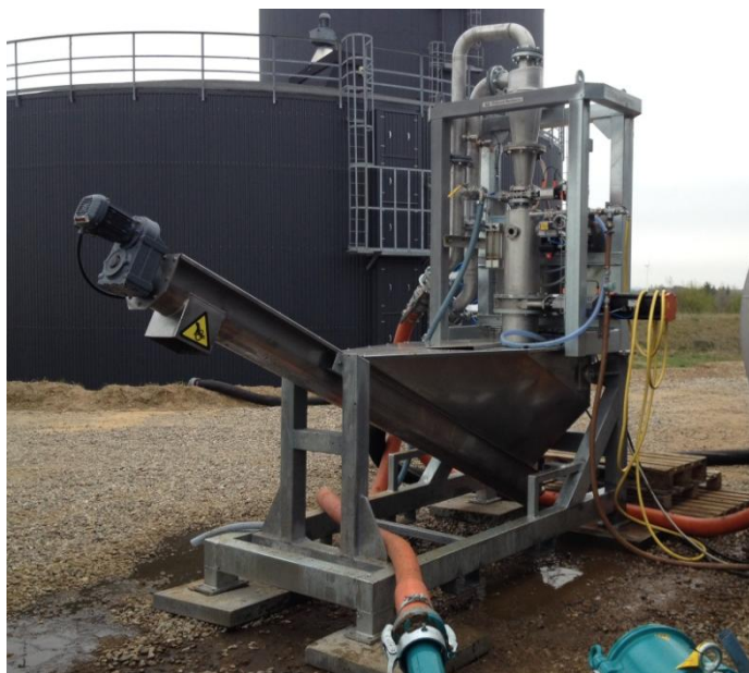
Billede 26: Cellwood cyklon med kontinuerlig frænsning af sand
