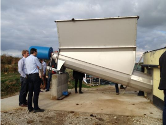
Billede 42: Påslag der vil kunne monteres i siden af fortank hos landmand til indfødnings af dybstrøelse og halm
