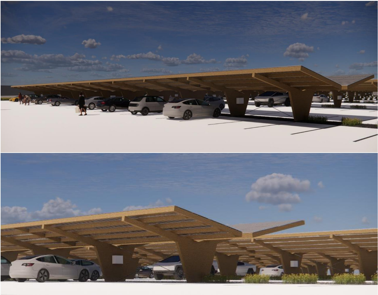
Figur 10 3D modul – felt bestående af 6 sammenhængende moduler – på hver 8 P. felter. Opstilles i rækker på 6 moduler – er hvert felt 60 meter og overdækker 48 parkeringsbåse. Der afvandes ned i et eksisterende nedsvinnings rabat på 1,5 m i bredden. Skruefundamenter muliggør at der kan fremføres elforsyning til ladere.
