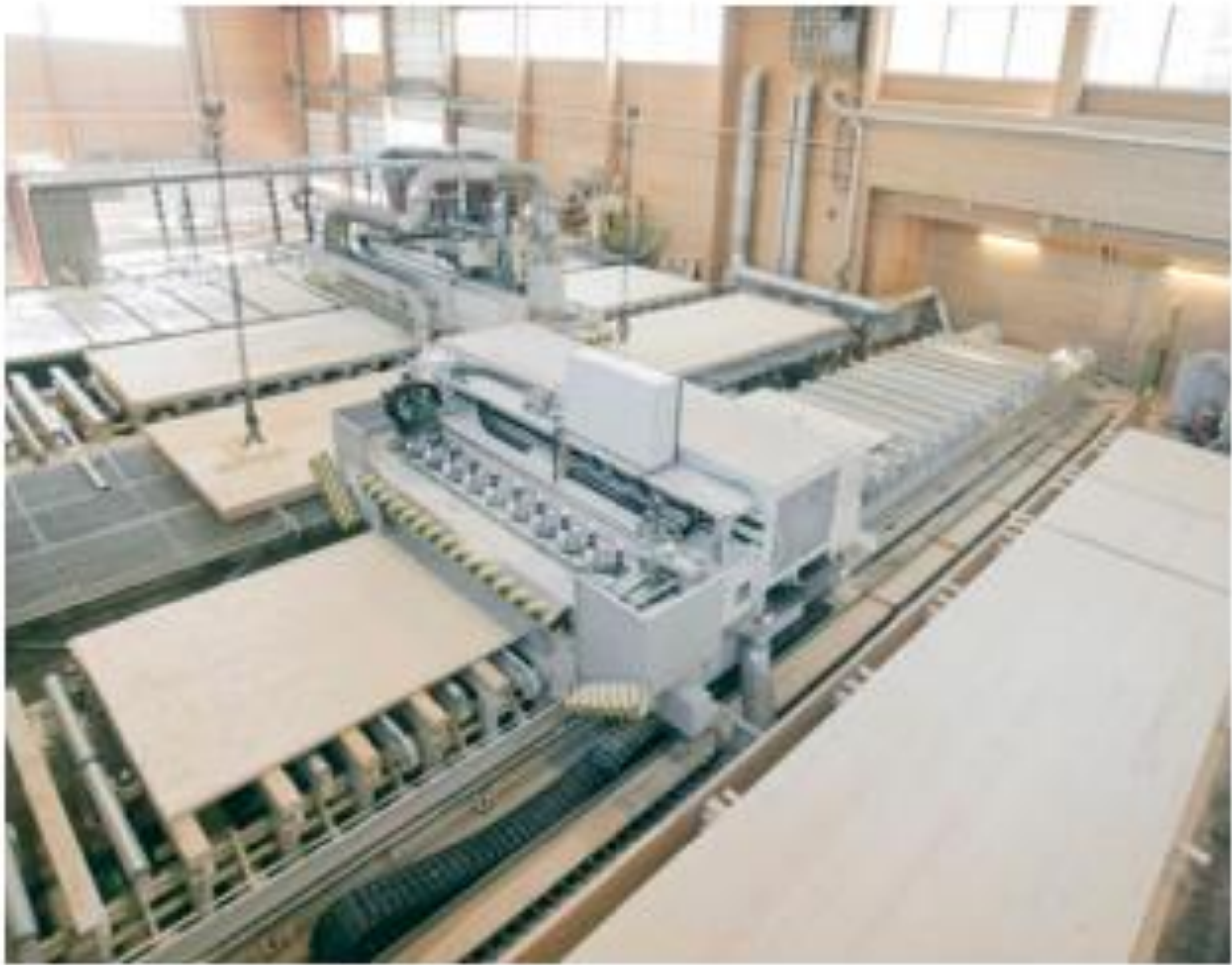
Figur 5 Bærende træstruktur i CLT elementer, præfabrikeres hos producenten ud fra store CLT elementer, der fra producentens side udskæres af CNC maskiner og leveres efter "Just-in-time" princippet. Designet er tilpasset et CLT elements mål, så der kan udskæres flest mulige af et element og spildmateriale reduceres.
