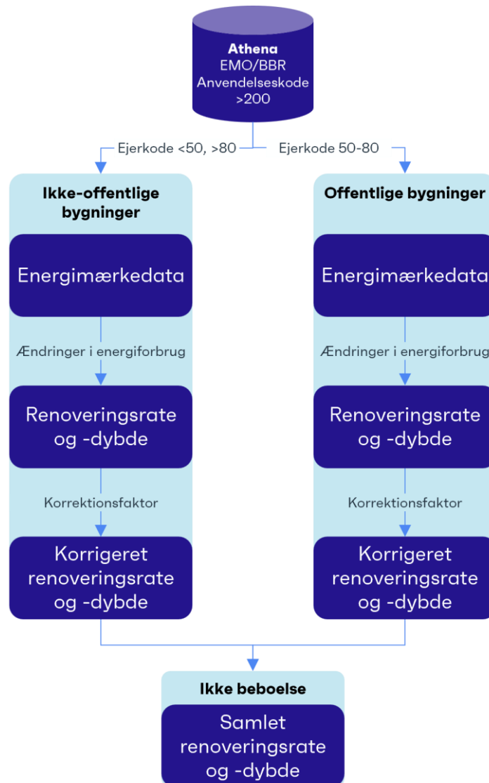
Figur 8. Oversigt over metoden for ikke-beboelse, med spor for hhv. ikke-offentlige og offentlige bygninger, som til sidst kombineres i en samlet renoveringsrate og -dybde.
