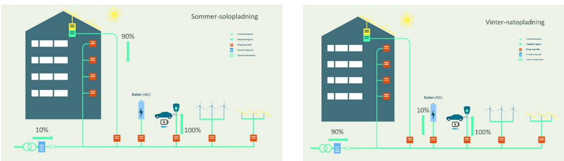
Figur 6 - Overblik over hvordan de forskellige komponenter i energifællesskabet er koblet til elnettet. Til højre ses en sommer opladning og til venstre en vinter netoplading. Det ses hvordan solceller og batterier anvendes i forskellige situationer.
