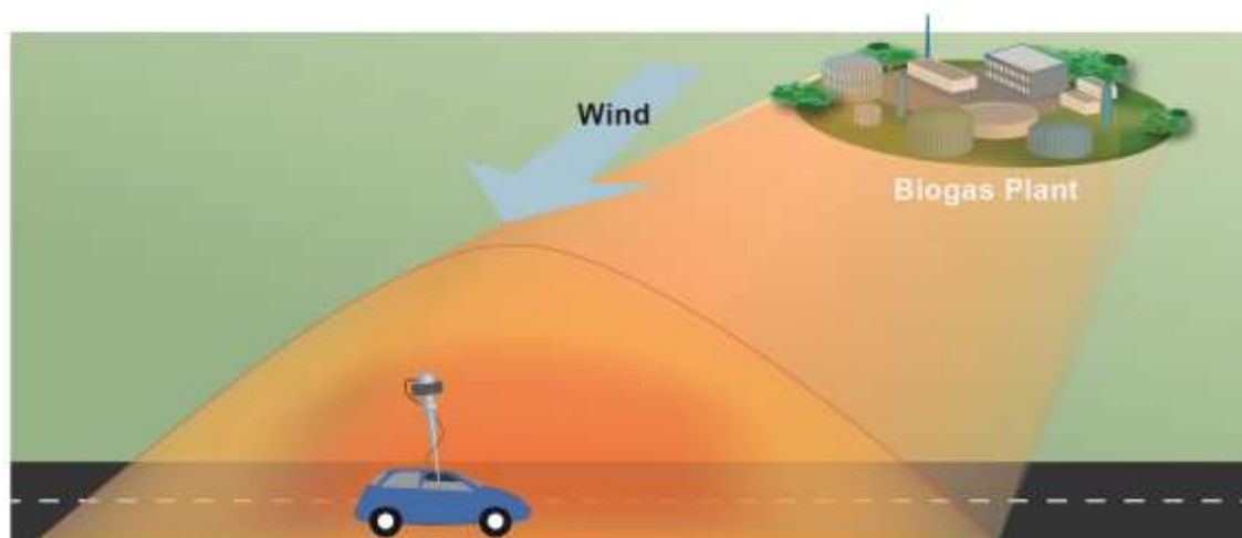
Figur 2 Den dynamiske sporgasdispersionsmetode. Kilde: C. Scheutz, DTU Miljø, med tilladelse.
