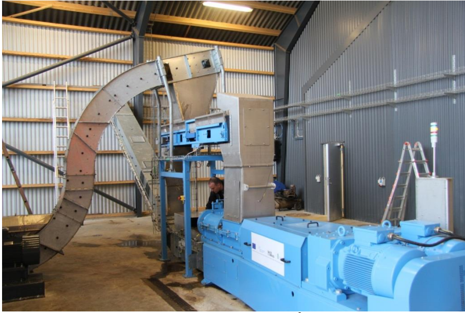
Figur 1. Ekstruder og indfødningsystem installeret på Aarhus Universitets biogas-anlæg i Foulum. Systemet kan behandle eksempelvis halm forud for udrådning i en biogasreaktor.
