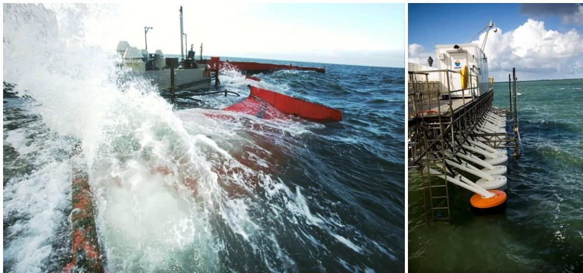
Figure 1. Prototypeafprøvning af Wave Dragon (tv.) og Wave Star (th.) i Nissum Bredning.
