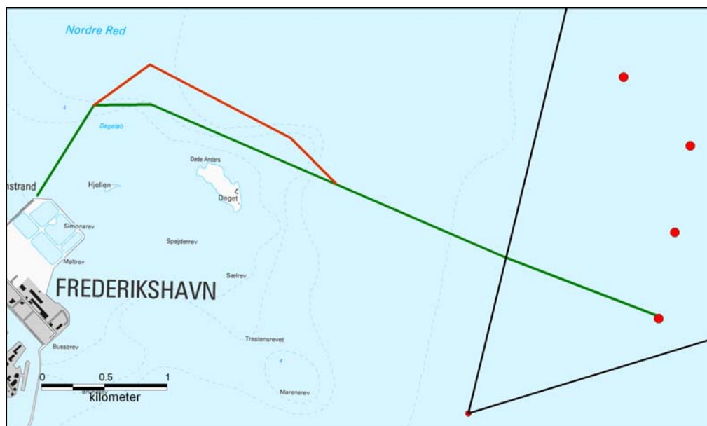
Figur 2: Oversigtskort, der viser en del af forsøgsmølleområdet syd-øst for Hirsholmene, de 4 sydligste møllers placering samt kabeltracéet (grøn linie) og alternativ kabeltracé (rød linie)
