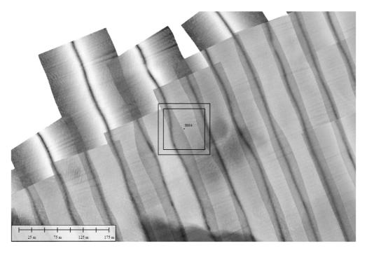
*Figur 1* Sidescan sonar mosaik (se Bilag D til miljøkonsekvensvurdering) omkring borehul 4 (BH4).
