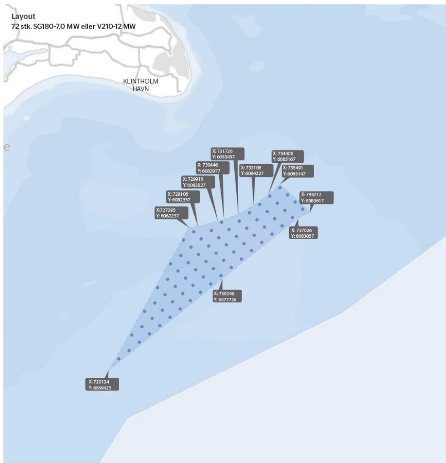
Figur 1 Kadetbanke sydøst for Møn. Skitse for opstilling af 72 stk. 7 MW møller
