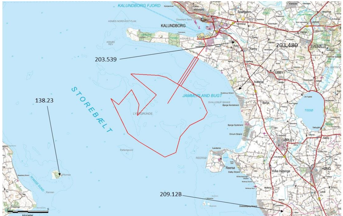
Figur 6-6: Som grundlag for den geologiske model er anvendt nærliggende dybe borer på land, som er tilgængelige via JUPITER databasen. Boringerne har en boringsdybde på ca. 40-60 meter og er jævnt fordelt henover nærområdet.
