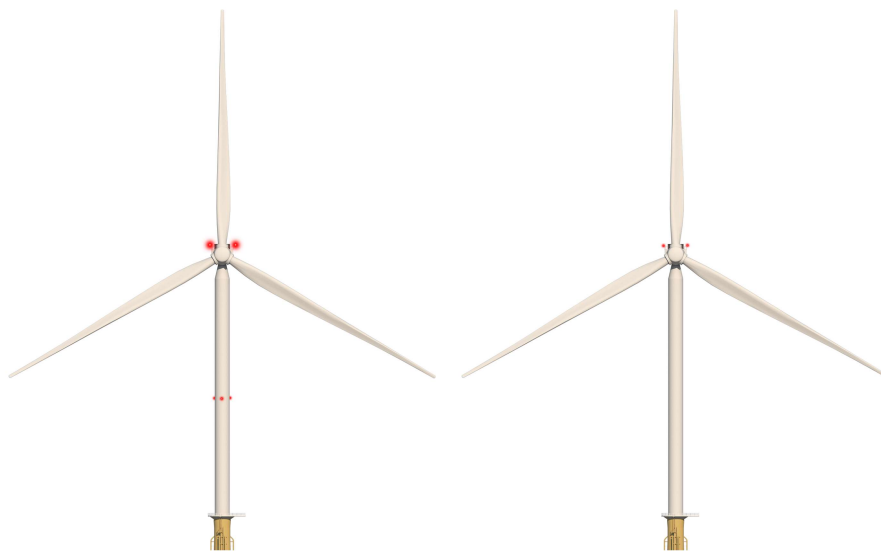
Figur 10-1 Anvendt lysafmærkning af havvindmøller. Til venstre: Afmærkning på havvindmøller i placeret i knæk og hjørner af havvindmølleparkens perimeter. Til højre: Afmærkning af resterende havvindmøller i havvindmølleparken.
